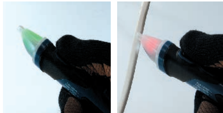
電源ONで緑色、電圧検出で赤色に点灯
