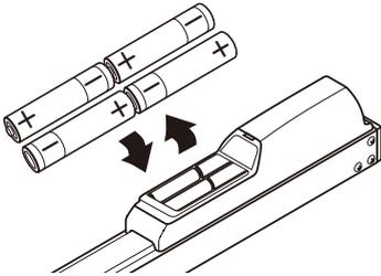
2. 消耗電池を4本とも取り出し、新しい電池を+、-の向きを表示通り正しく入れてください。
