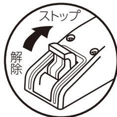
※最終段ストップは摩擦力により制動していますので、ポールへの油の付着にはご注意ください。
