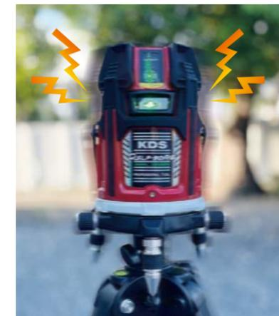
本体の大きな揺れや衝撃を検知し、レーザーラインの消灯とLED点滅、ブザー音でお知らせ。意図しない測定間違いを防止します。
