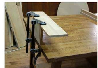
樹脂パッドを外せば溶接作業で仮止め作業に使用可能
