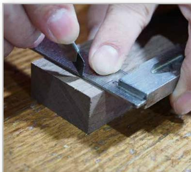
片刃を使うと定規の間に隙間ができず、
