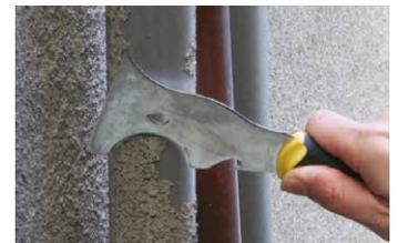
パイプなどの曲面の剥がし作業に
